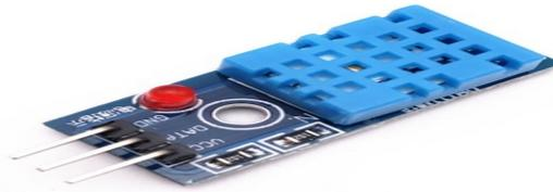
Figure 4: DHT11 Sensor
